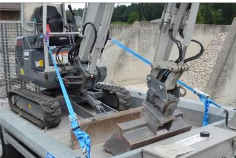
In der Bedienungsanleitung der Baugeräte wird beschrieben, wie die Maschinen gesichert werden. Bei fehlenden Anschlagpunkten kann der Überrollbügel als Anschlagpunkt verwendet werden. Dieser ist ausreichend stabil, da er das ganze Gewicht des Raupenbaggers beim Umkippen halten muss. Durch die höhere Platzierung der Rundschlingen, kann der Raupenbagger auch nach unten gesichert werden.
