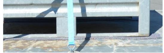
Kopfschlinge mit Rundschlinge 3.20 m und Zurrurt 2-teilig 1000 daN als formschlüssige Sicherung in Verbindung mit Zurrurt 2-teilig 1000 daN als kraftschlüssige Sicherung.
