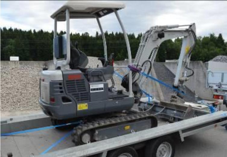
Kombinierte Sicherung des Raupenbaggers. Mit 2 Zurrgurten 2-teilig 2500 daN oder 1000 daN und einem Schäkel wird der Raupenbagger nach hinten gesichert. Mit 2 Zurrgurten 2-teilig 1000 daN und 2 Rundschlingen 1.00 m wird der Raupenbagger nach vorne und unten gesichert und kommt in den Formschluss.
