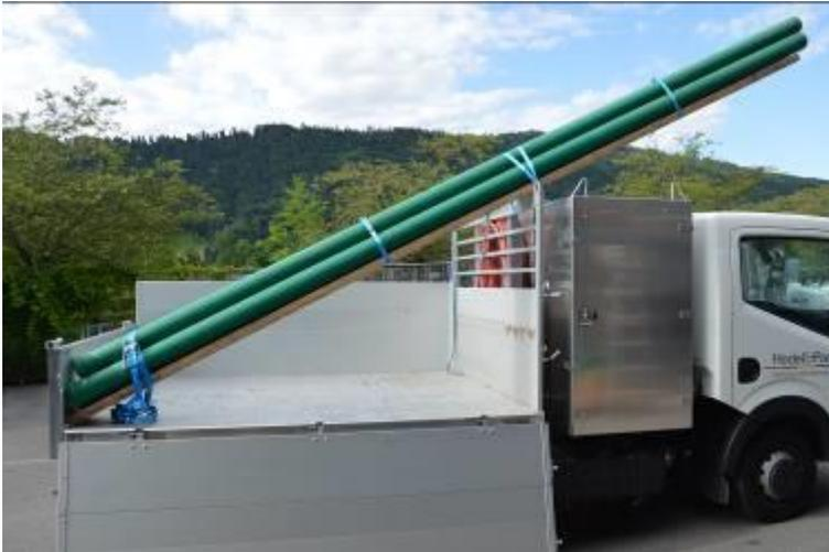
Damit Kunststoffrohre transportiert werden können, benötigen sie eine stabile Unterlage, welche mit einem Gerüstladen erstellt wird. Die Rohre werden mit zwei Zurr Gurten mit Gurtbandklemme Länge 1.2 m gebündelt. Mit einem Zurr gurt mit Gurtbandklemme 4 m wird das Bündel oben an der Rückwand gesichert. Unten wird das Bündel am Anschlagpunkt mit einem Zurr gurt 2-teilig 1000 daN gesichert und kann sich so seitlich nicht verschieben.
