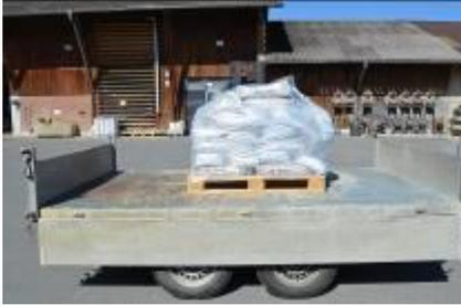
Sicherung von Sackwaren wie Dünger und Samen. Das Gurtbandnetz wird in Verbindung mit zwei Zurrgurten mit Gurtbandklemme, Länge 1.20 m, straff um die Säcke fixiert. Mit 4 Schnellspannern wird die Ladung formschlüssig gesichert, sowie mit zwei Zurrgurten 2-teilig 1000 daN zusätzlich kraftschlüssig gesichert.
