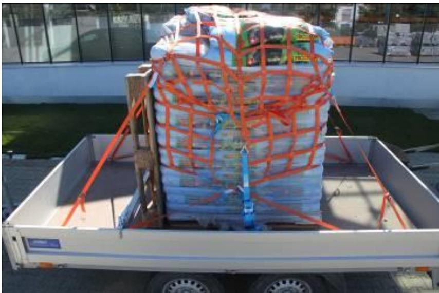
Sicherung von hoher Palette mit Sackerde. Das Gurtbandnetz wird in Verbindung mit 2 Zurrgurten daN 1000 und 2 Zurrgurten mit Gurtbandklemmen Länge 1.2 m gesichert. 8 Zurrgurten mit Gurtbandklemmen inkl Profilhacken sorgen für den Formschluss. Das Gurtbandnetz hat 4 Ringe aussen und 4 Ringe in der Mitte des Netzes, damit die Zurrgurten optimal angeschlagen werden können. Hohe Paletten werden zusätzlich mit dem Klemmbalken und einer stehenden Palette in den Formschluss gebracht.
