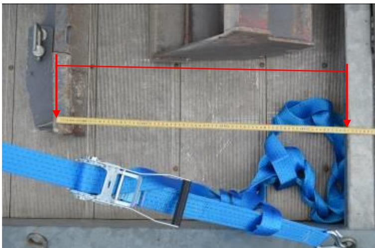
Bei Baugeräten wie zum Beispiel Raupenbagger kann nach dem Messen ein Foto mit der Position der Maschine erstellt werden. So kann man das Mass vom Schild bis zur Stirnwand des Anhängers messen und das Foto zusammen mit dem Fahrzeugausweis beim Anhänger deponieren. So kann die Maschine jederzeit korrekt verladen werden.
