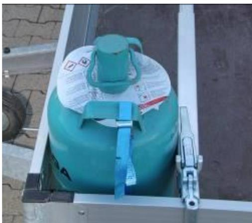
Sicherungsvarianten von rundem Transportgut wie z.B Gasflaschen.
