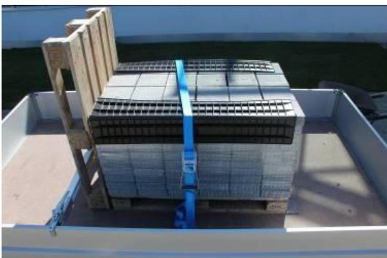
Formschlüssige Sicherung mit Einsatz eines Klemmbalkens 1000 daN und Zurrurt 2500 daN.
