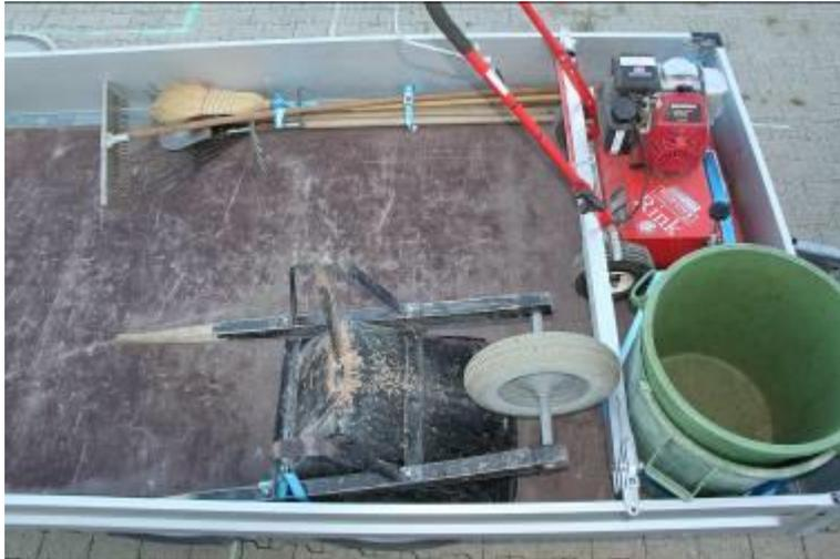
Mit dem Klemmbalken können kleine Maschinen auf Rädern formschlüssig geladen und mit einer Zurrgurte daN 1000 fixiert werden. Diverses Kleinwerkzeug kann mit Zurrgurten mit Gurtbandklemmern über die Anschlagpunkte der Ladefläche gesichert werden.
