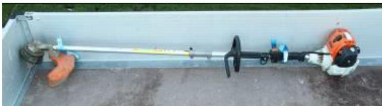
Formschlüssige Sicherung mit 2 Zurrgurten mit Gurtbandklemmen (über die Anschlagpunkte der Ladefläche).
