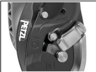
Mit dem zusätzlichen offenen Bremsselement lässt sich die Bremsreibung entsprechend der Last und dem Seildurchmesser erhöhen und das Seil kann jederzeit eingelegt oder herausgenommen werden.
